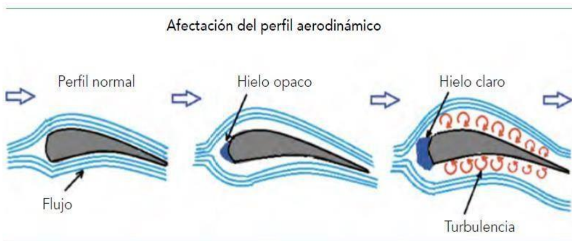
Figura 4. Interacción entre el tipo de hielo y el flujo de aire. Adaptado de FAA (2015).
