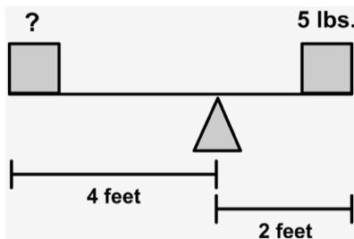
Se tiene una viga en perfecto equilibrio apoyada sobre un soporte triangular, hacia la derecha hay una carga de 5 libras a una distancia de 2 pies, hacia la izquierda hay una carga X a una distancia de 4 pies. ¿Cuál es el peso del objeto de la izquierda para que la viga se mantenga en equilibrio?
