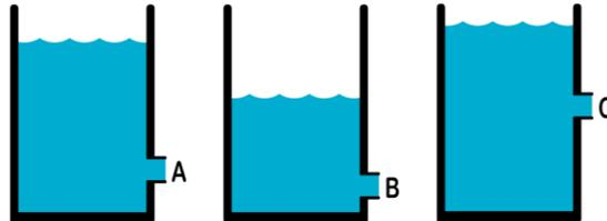
Se tiene tres tanques de agua con una salida ubicada en diferentes alturas. Según la imagen, ¿Cuál de las tuberías tendría agua a mayor presión y velocidad?
